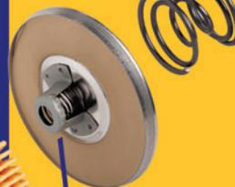
**Soupape de décharge** - Lorsque le média bloqué, la soupape de décharge s'ouvre et permet à l'huile non filtrée de contourner le média filtrant pour aider à prévenir le manque d'huile.
