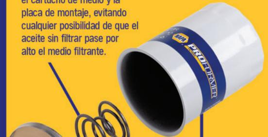
**Válvula de alivio** - Si el medio filtrante se llegara a bloquear, la válvula de alivio se abrirá permitiendo que el aceite llegue al motor evitando la falta de lubricación en el sistema.
